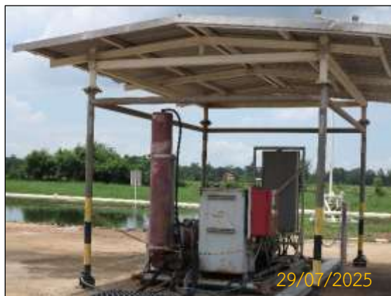
ภาพที่ 2.2-11 ระบบ Gas lift
